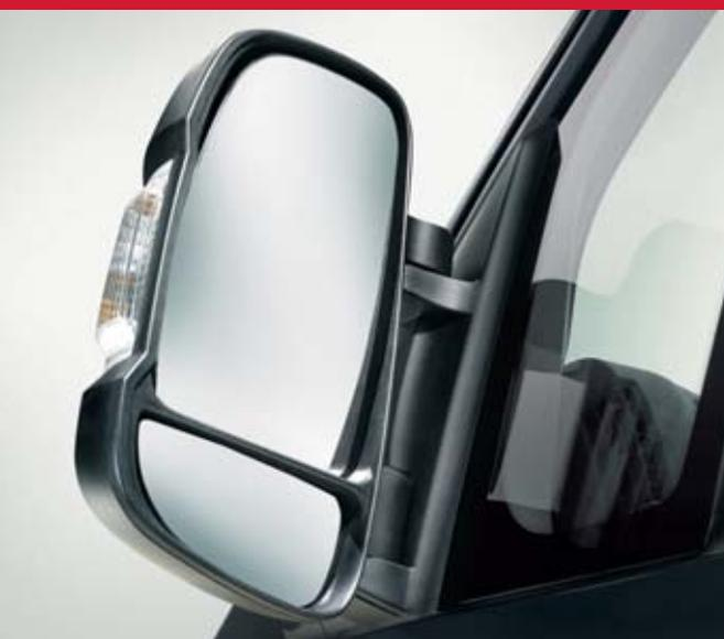
**Specchietti regolabili ed abbattibili elettricamente.** Gli specchi retrovisori a doppia parabola di Nuovo Ducato garantiscono una visione posteriore panoramica unita alla massima praticità di utilizzo, in quanto possono essere regolabili ed abbattibili elettricamente dall'interno. Entrambe le parabole sono regolabili indipendentemente per adattarsi a tutti gli utenti.
