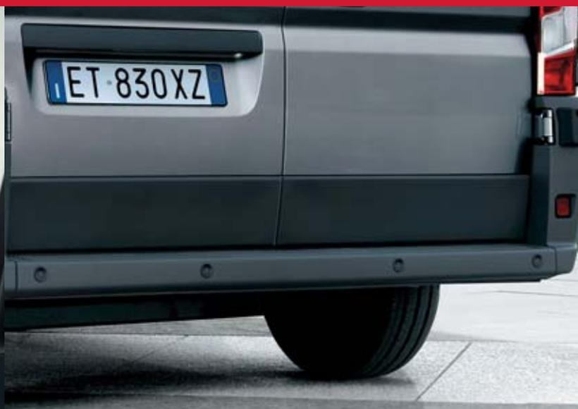
**Sensori di parcheggio.** I sensori di parcheggio a ultrasuoni si attivano a retromarcia innestata e segnalano al guidatore l'approssimarsi di un ostacolo mediante un suono intermittente.
