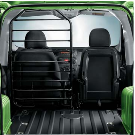
Scaletta tubolare metallica di protezione guidatore.
