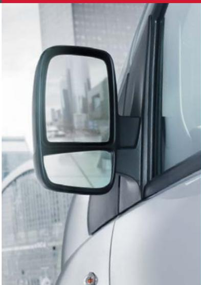
Specchietti retrovisori a doppia parabola, per migliorare la visibilità posteriore. L'apertura e la chiusura degli specchietti può essere comandata elettricamente.
