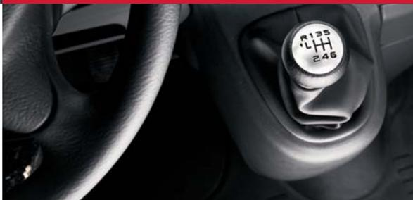
Cambio a 5 o 6 marce a seconda delle motorizzazioni, con leva sulla plancia.
