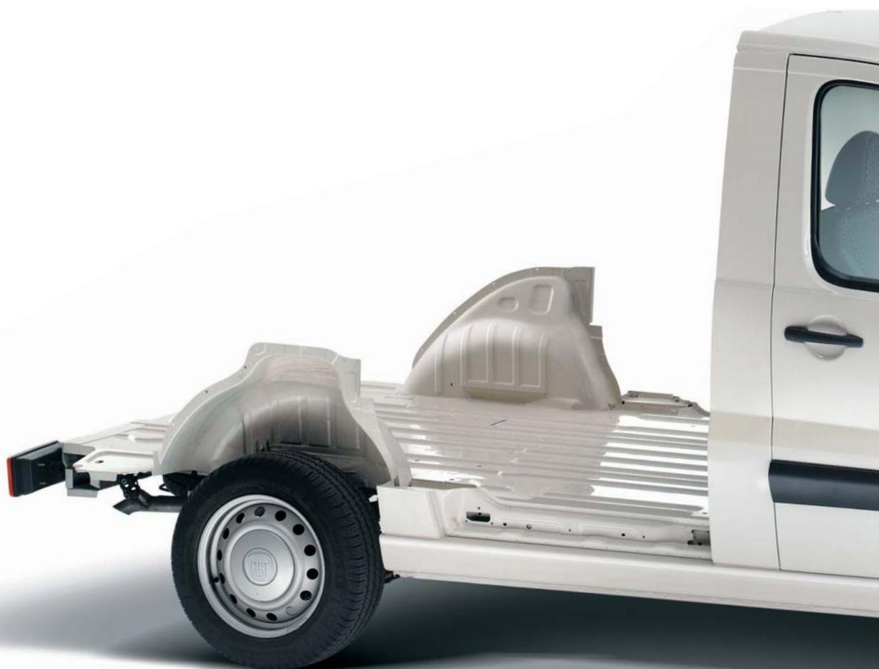
Gli interventi di carrozzieri e allestitori sono agevolati da predisposizioni strutturali ed elettriche che permettono una connessione agevole tra il cabinato con pianale e le varie trasformazioni. Se le vostre esigenze lo richiedono, è disponibile un kit di estensione della carrozzabilità fino a 2,10 m.
